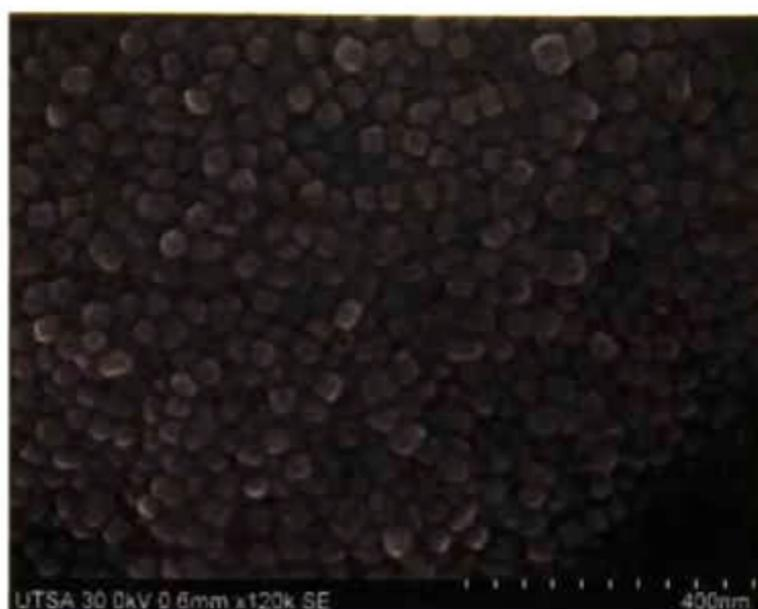
Figura 5.53 Micrografía SEM que muestra el tamaño de las partículas de óxido de níquel soportadas sobre la sílice.
