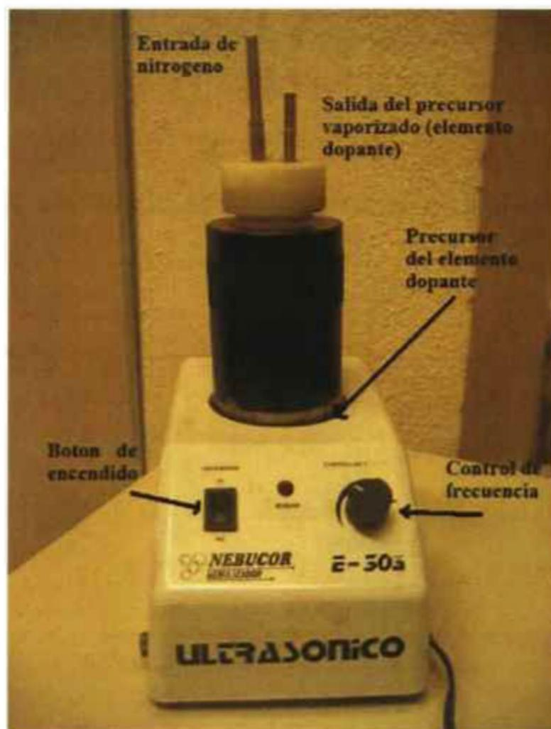
Figura 4.5 Nebulizador marca NEBUCOR Ultrasonico E-303, usado para vaporizar el precursor con el elemento dopante.
