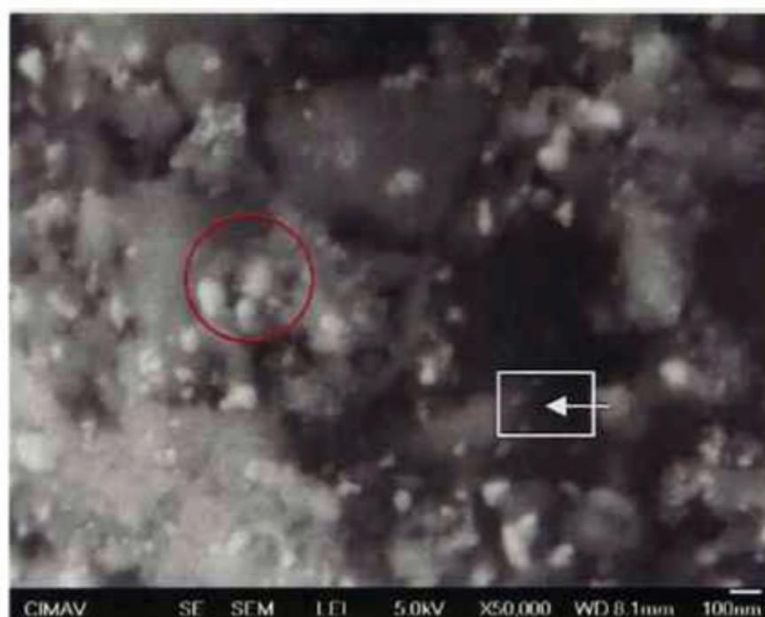
Figura 5.72 Imagen de SEM para las nanopartículas de  $\text{MoO}_3$  soportadas sobre sílice sol-gel (50%  $\text{MoO}_3$  - 50%  $\text{SiO}_2$ ). Círculo rojo: aglomerados de óxidos de molibdeno con sílice. Recuadro blanco y flecha: partículas con tamaños entre 15 y 20 nm.
