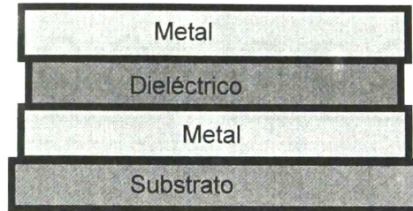
Fig. 4-2. Estructura de los dispositivos MIM, Metal-Dieléctrico-Metal.
