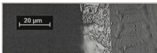
Figura 4-40 Imagen de sección transversal de la película de CdTe obtenido en vacío a temperatura fuente-sustrato de 620-500 °C con tiempo de depósito de 5 minutos
