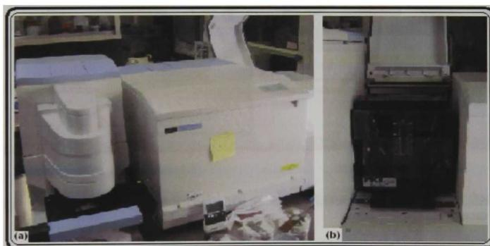
Figura 4.11. (a) Equipo de infrarrojo FTIR Spectrum GX (Perkin Elmer) y (b) Accesorio de reflectancia especular VeeMAX™ II.
