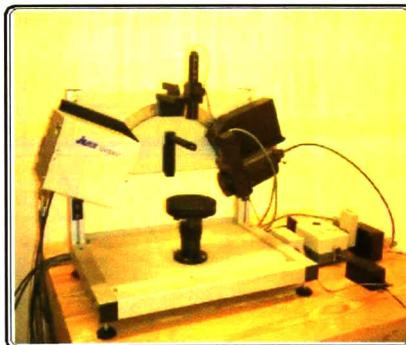
Figura 4.9. Elipsómetro Jobin Yvon-Uvisel DH10.
