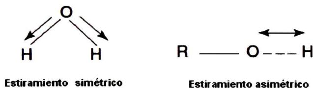
Figura 2.6. Estiramiento simétrico y asimétrico.
