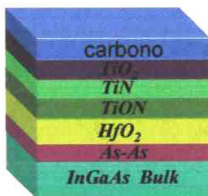
Figura 6.1 Modelo multicapas propuesto para el análisis de datos en el XPSGeometry.
