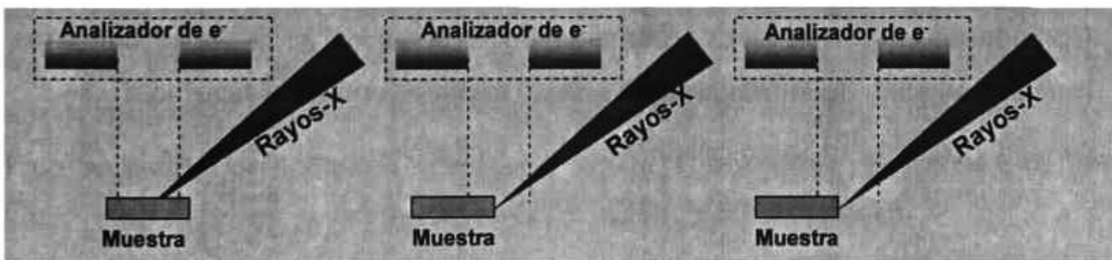
Figura 4.5 Esquema general de la muestra que se va alejando del spot de la fuente de rayos-X.
