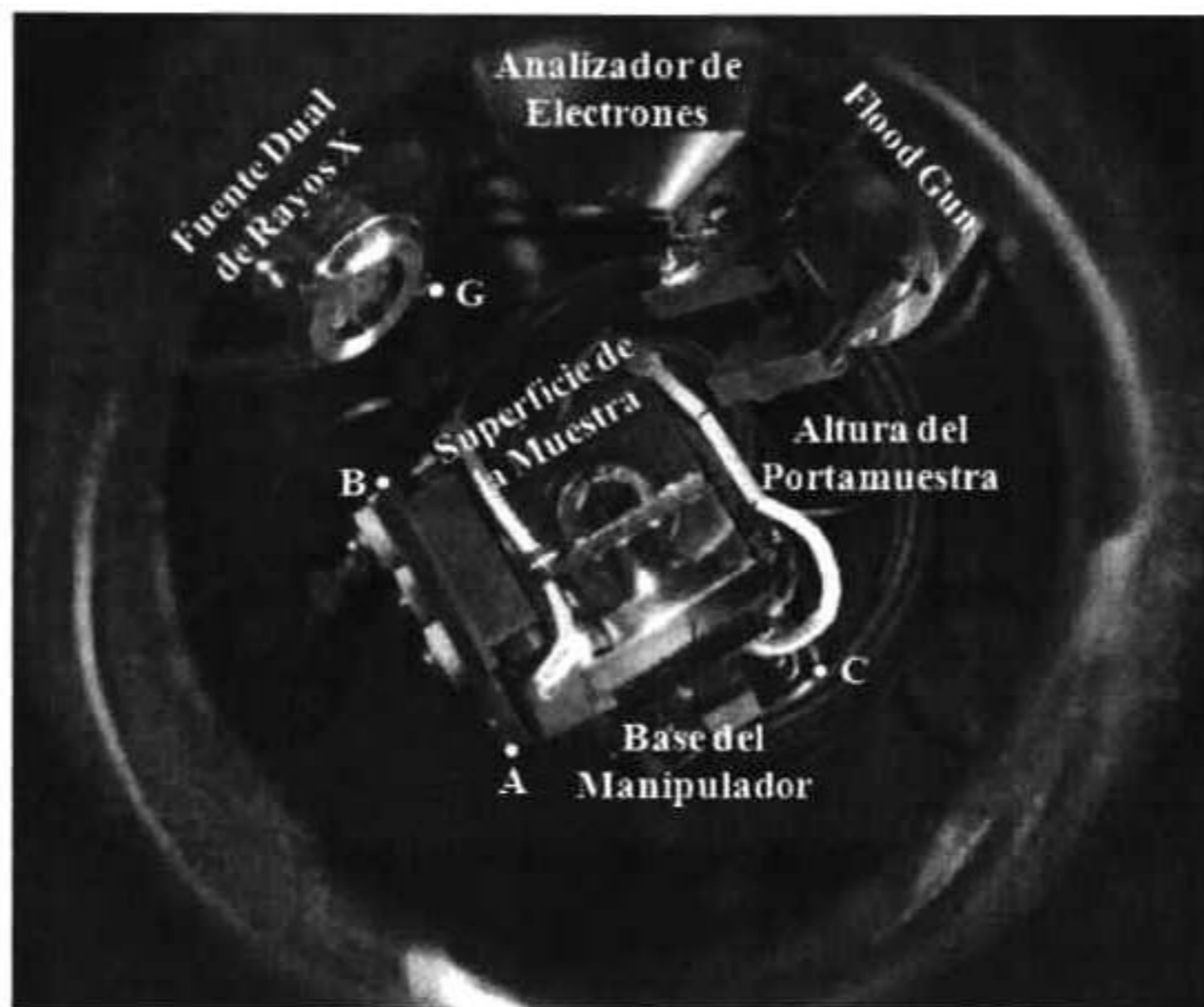
Figura 4.2 Imagen del manipulador a 30° con respecto a la horizontal de la muestra.
