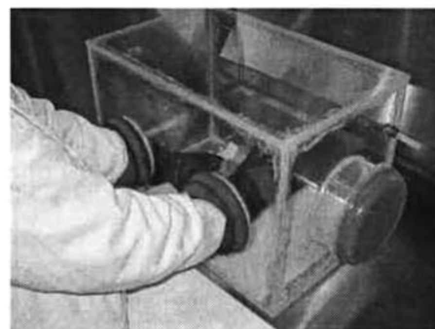
Figura 4.1. Caja de guantes usada para preparar las soluciones precursoras de TiO 2 , utilizando atmósfera de nitrógeno.
