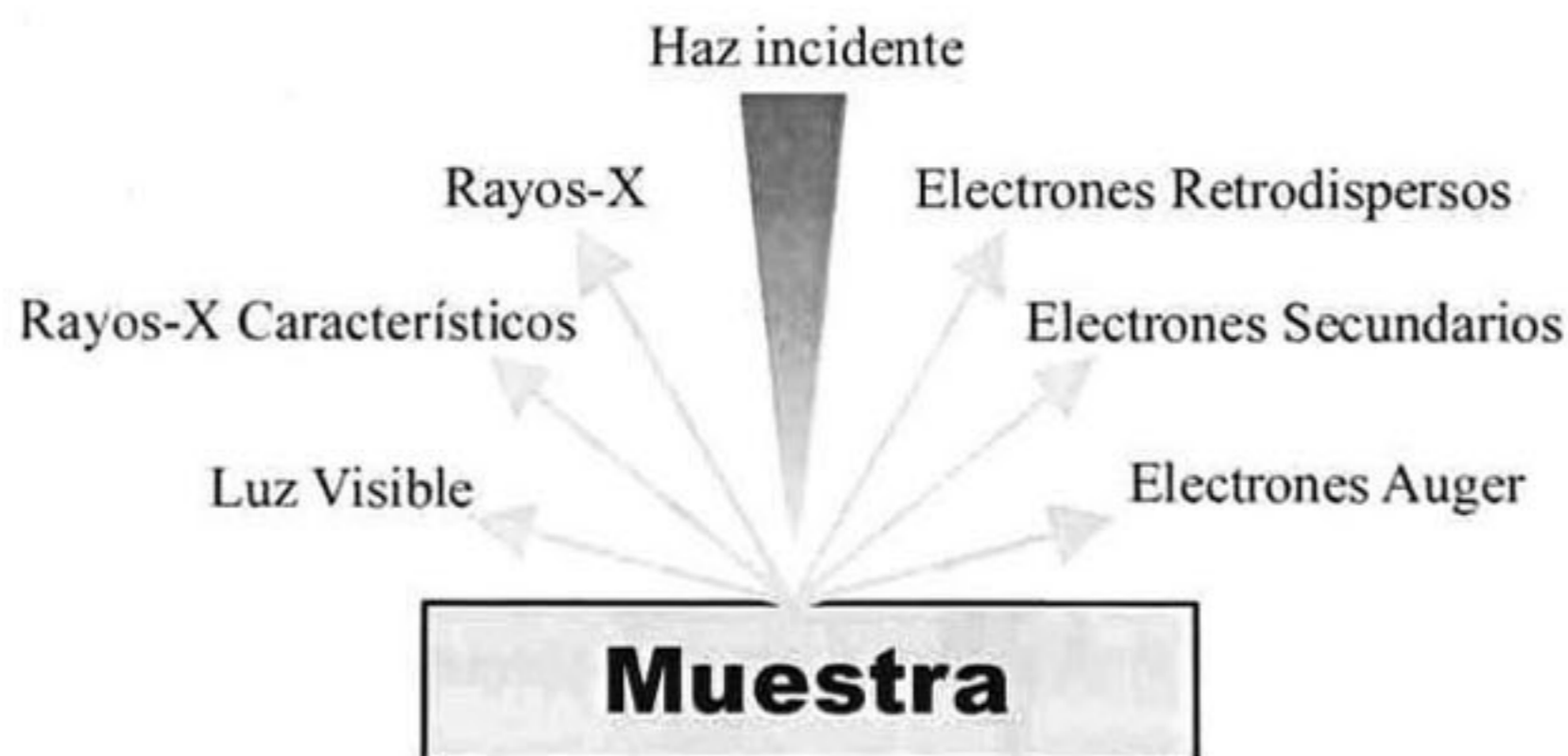
Figura 3.9: Diagrama de las señales generadas cuando índice un haz de electrones sobre una muestra.
