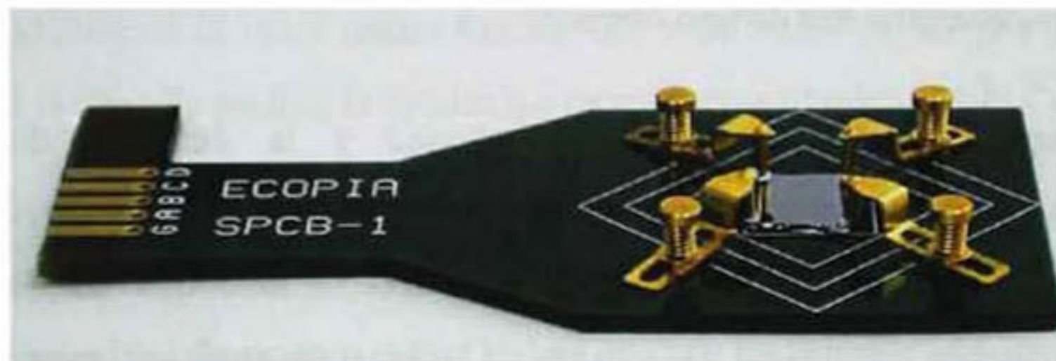
Figura 5.22: Porta-muestras “ Spring Clip ” para conexión tipo Van der Pauw para mediciones de efecto Hall.
