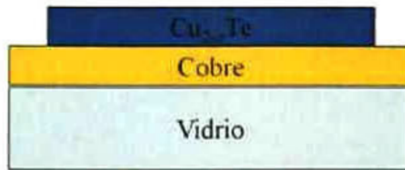
Figura 5.8: Perfil propuesto para muestras de \text{Cu}_{2-x}\text{Te} crecidas a altas temperaturas del sustrato.
