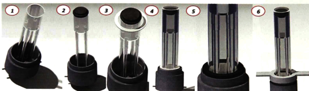
Figura 9. Procedimiento de ensamblaje del reactor
