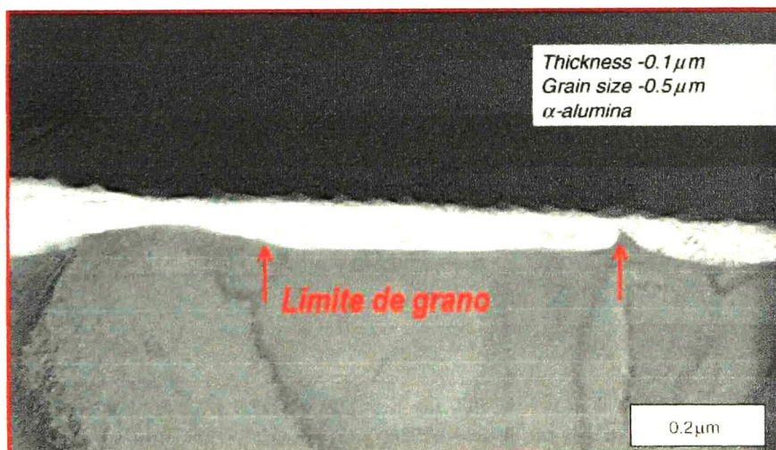
Figura 2. 20. Sección Transversal de Muestra Pre-oxidada en Intermedia pO_2 [5] .
