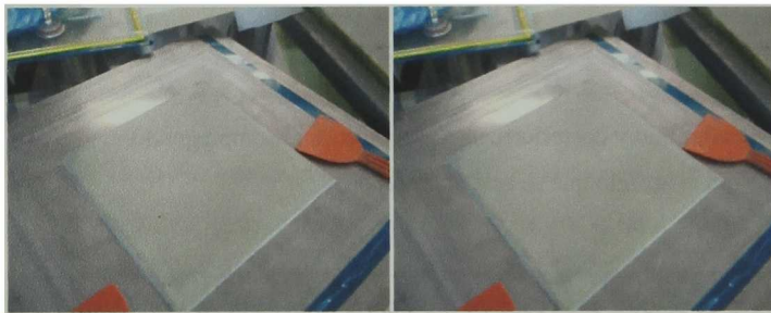
Figura 5.7.- Desmolde de los FML's terminados.
