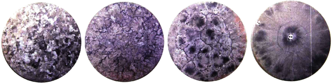
Figura 4.19 Macrografías de las aleaciones Al-Si sin modificar y modificadas con 78, 152 y 315 ppm de estroncio.
