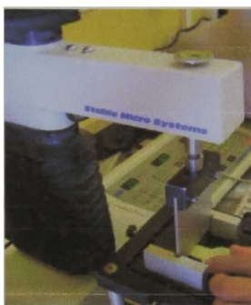
Figura 20. Prueba de resistencia al corte en tortillas utilizando el Texturómetro (Texture Analyzer, TA-TX2)
