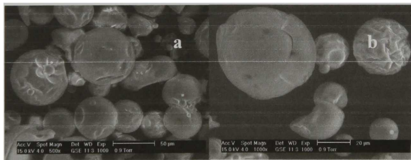
Figura 21. a), y b) Micrografías de ESEM de la inulina a diferentes aumentos.
