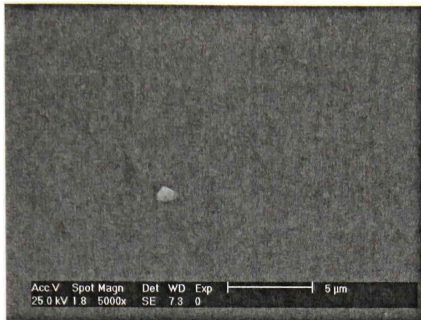
Fig. 4.78. Microscopia de series H7 de CdSe con 10 min de síntesis a 5000 X de aumento
