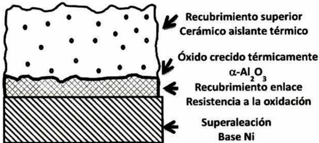
Figura 7. Configuración básica de sistemas TBC.
