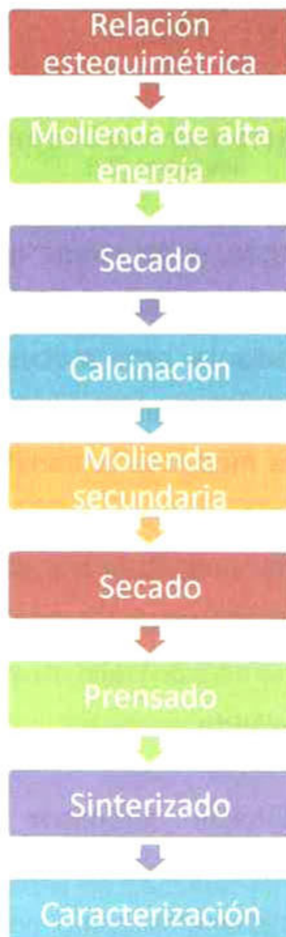
Figura 11. Diagrama de flujo del procesamiento de materiales cerámicos mediante reacción de estado sólido asistido por molienda de alta energía [24].
