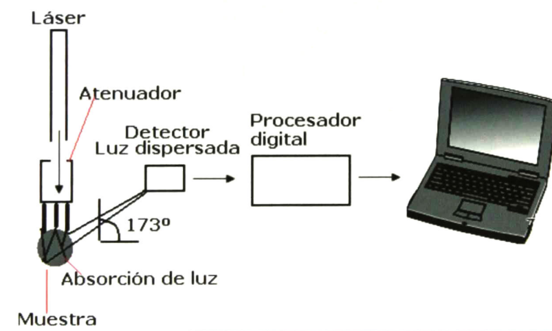
Figura 4.8 Esquema del funcionamiento del equipo de DLS
