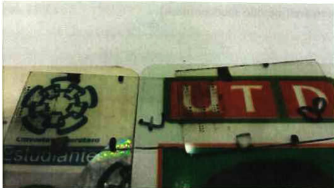
Figura 57. Fotografía de los dispositivos TFTs son altamente transparentes, solo los contactos de aluminio pueden apreciarse.
