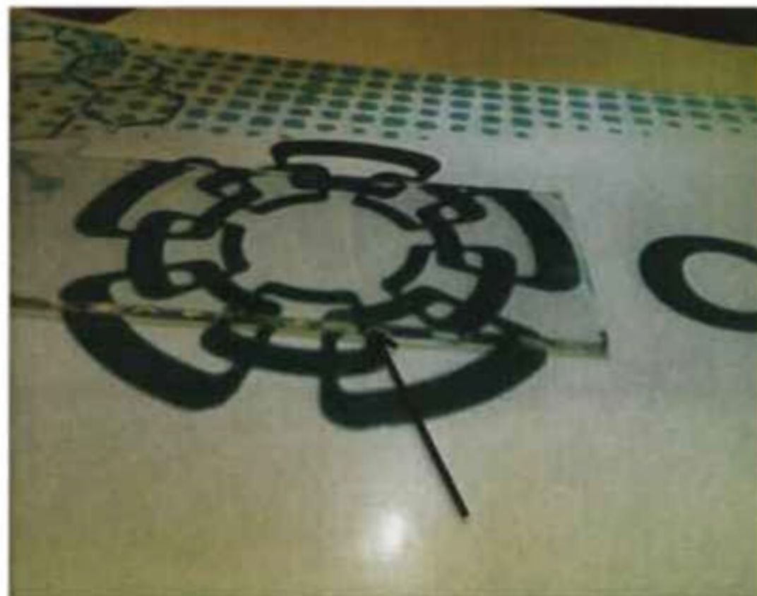
Figura 20. Fotografía de la película de TiO 2 -PMMA mostrando la alta transparencia y homogeneidad.
