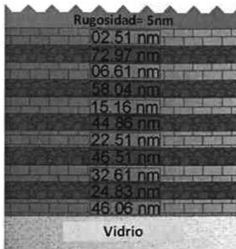
Figura 10. Modelo multicapa usado para ajustar los espectros de las películas de \text{In}_2\text{O}_3 constituidas de 6 recubrimientos. Las capas de color verde indican solamente material de óxido de indio, mientras que las capas moradas indican combinación de espacio vacío y material de óxido de indio. El espesor de cada capa está indicado en la figura.
