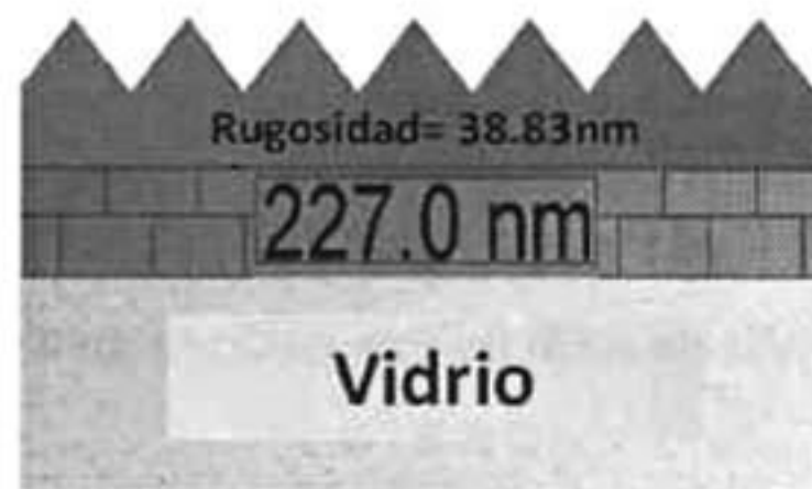
Figura 21. Modelo usado para modelar los espectros de las películas de CdO de 6 recubrimientos. La capa color verde indican material de óxido de cadmio, la capa azul es la rugosidad del material. El espesor de cada capa está indicado en la figura.
