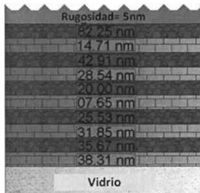
Figura 15. Modelo multicapa usado para ajustar los espectros de las películas de \text{CdIn}_2\text{O}_4 de 6 recubrimientos. Las capas color verde indican solamente material de indato de cadmio, mientras que las capas moradas indican combinación de espacio vacío y material de indato de cadmio. el espesor de cada capa está indicado en la figura.
