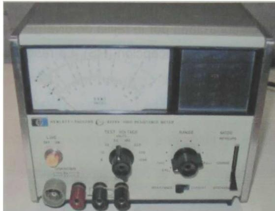
**Figura 5.3** Sistema de alta resistividad eléctrica HEWLETT-PACKARD 4329A, 0-1000V
