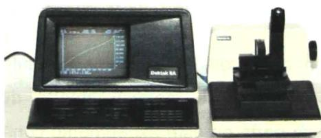
Figura. 5.1 Perfilometro mecánico marca DEKTAL II
