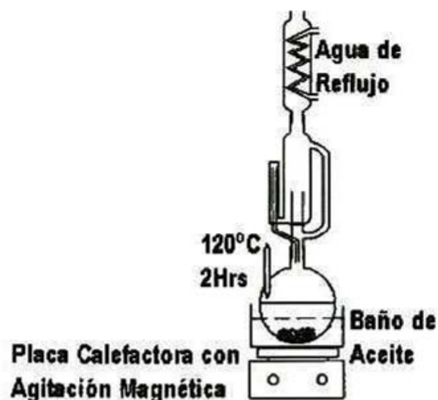
Figura 4.1, Imagen ilustrativa del proceso de tratamiento químico del Carbón Vulcan XC-72.
