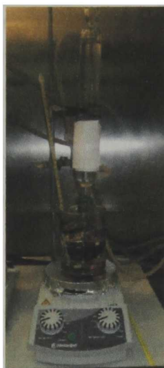
Figura 2.1.- Tratamiento térmico empleado, reflujo en baño de aceite para la síntesis de los materiales electrocatalíticos.
