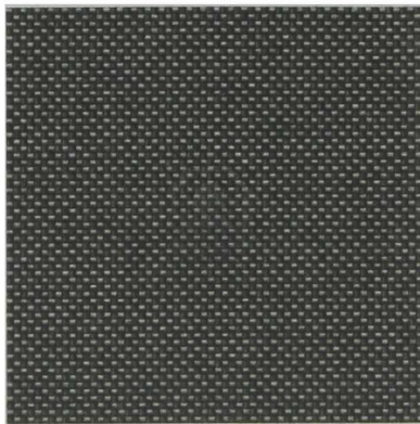
Figura 1.8.- Tela de carbón utilizada para la distribución de gases dentro de la celda de combustible
