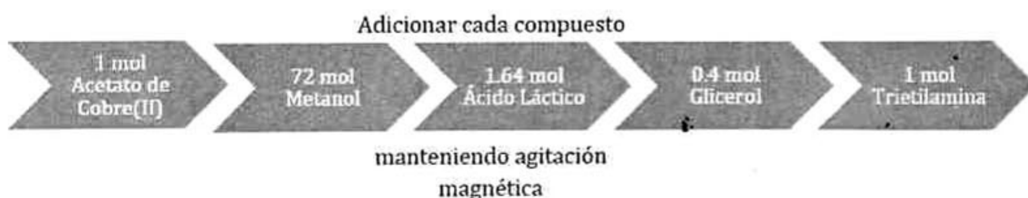
Fig. 3.1 Esquema del procedimiento de obtención de la solución precursora.
