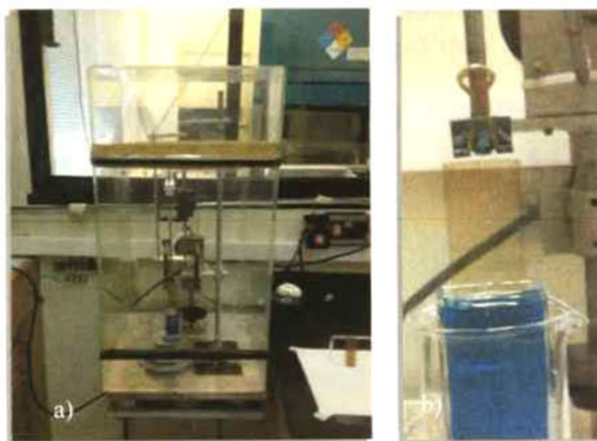
Fig. 3.2 a) Equipo de inmersión-remoción para recubrimiento de substratos. b) Remoción de substrato de la solución precursora simple.
