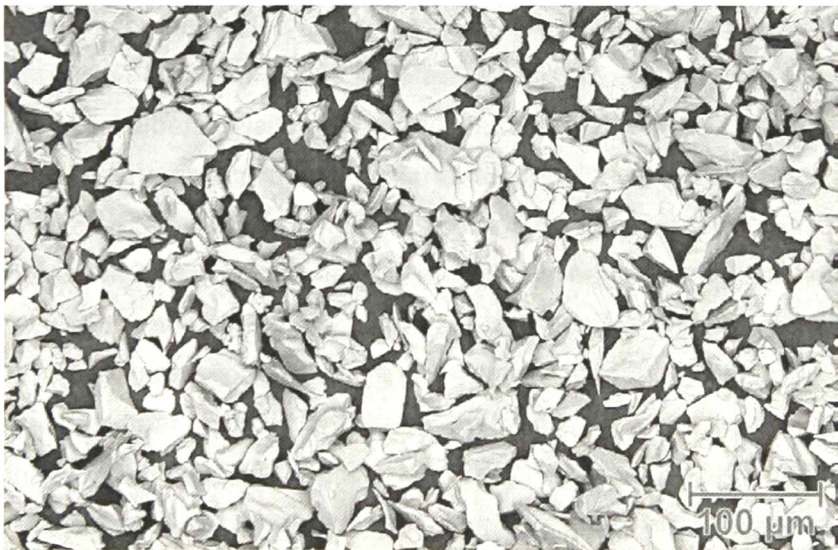
Figura 15. Partículas del polvo \text{TiO}_2 Metco 102 obtenidas por el método de fusión y partición.
