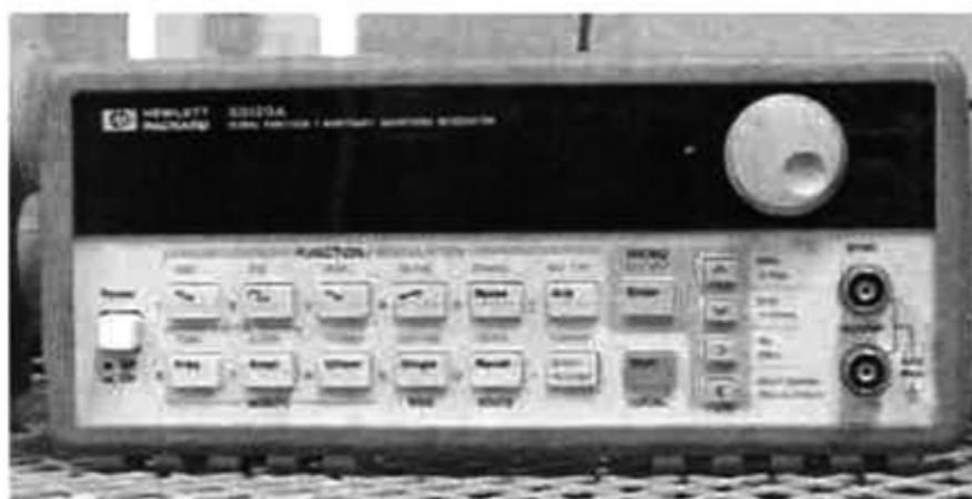
Ilustración 12.- Agilent/HP 33120A Waveform Generator
