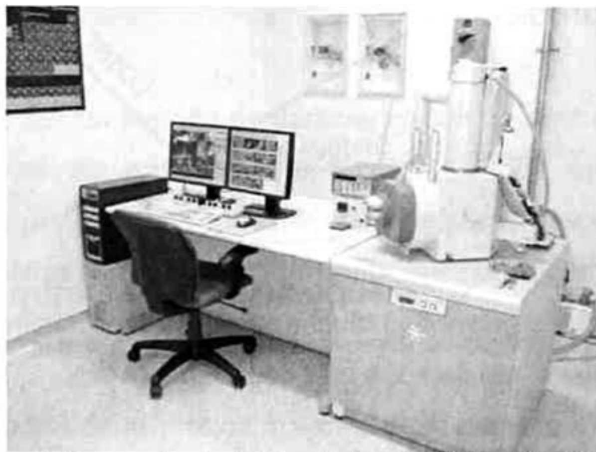
Imágen 2 Microscopio electrónico de barrido Philips XL- 30 ESEM.
