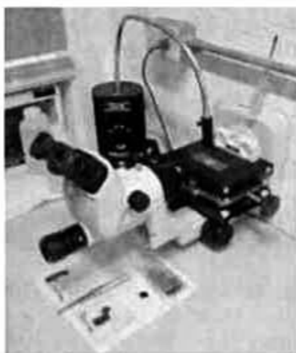
Imágen 6 Configuración del microscopio estereográfico para la captura de fotos de una gota, sobre la superficie CFRR
