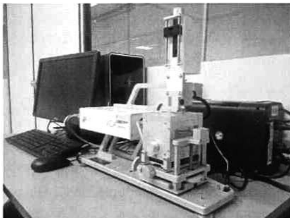
Imágen 15 Goniometro VCA Óptima™ utilizado en el análisis de superficies CFRR-3
