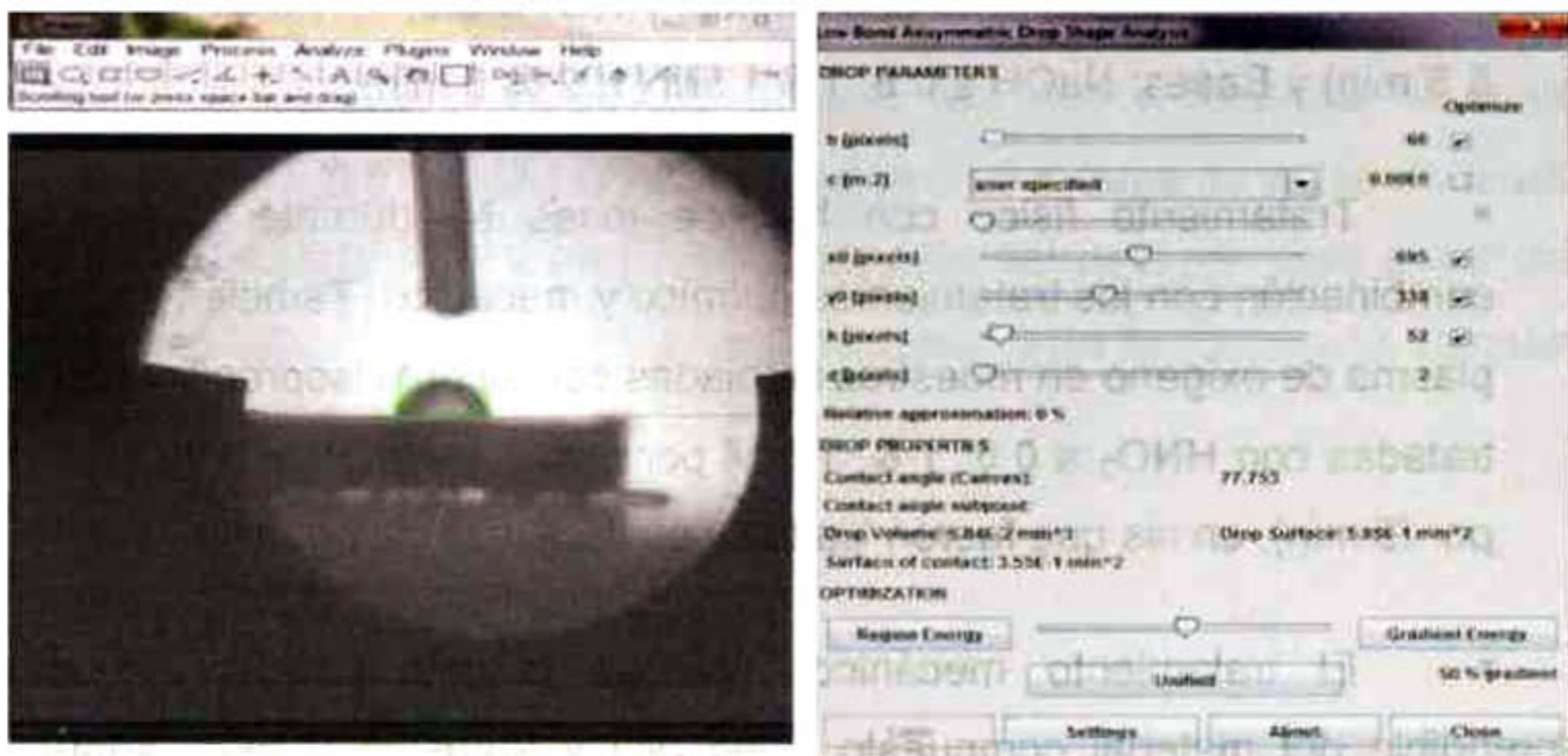
Imagen 10 Captura de pantalla para el procedimiento de contorno de una gota de agua de 1 \mu l depositada sobre una muestra CFRR-2 limpiada con alcohol isopropílico. La imagen fue obtenida con el goniómetro de la UNAM y para calcular el ángulo de contacto formado por la gota se utilizó el software ImageJ.
