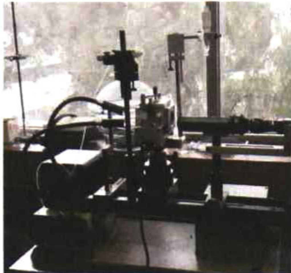
Imagen 9 Goniometro de la UNAM utilizado en la etapa 2 para capturar imágenes de gotas de agua depositadas sobre la superficie del material compuesto.
