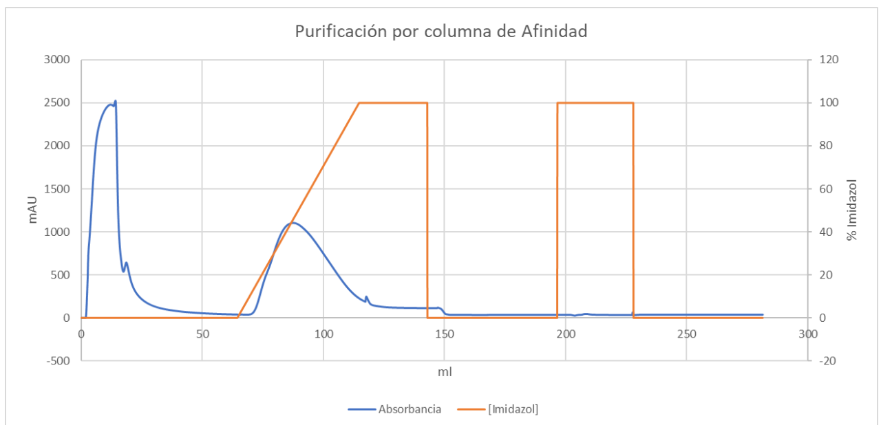
Figura 27. Cromatograma de la purificación de TrxA-hEGF mediante FPLC por afinidad a níquel
