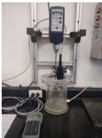
**Figura 5.** *Arreglo experimental para lixiviaciones de minerales industriales.*
