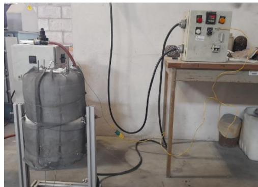
Figura 14. Horno vertical tubular y controlador de temperatura implementados para realizar el precalentamiento de las muestras.
