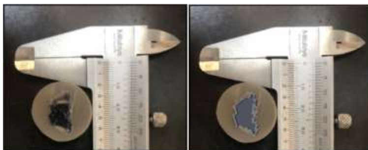
Figura 11. Área superficial de cristal de galena 113.7 \text{ mm}^2
