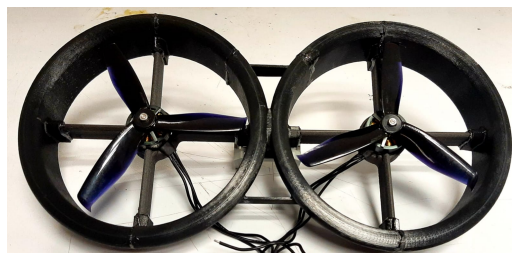
Figura 5.4: Fotografía del ensamblaje final del Dual Ducted-Fan con sus motores y rotores.
