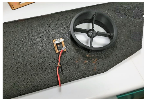
Figura 5.2: Fotografía del ensamble del Ducted-Fan dentro de la abertura de la semiala izquierda, cortada mediante la técnica de hilo caliente.
