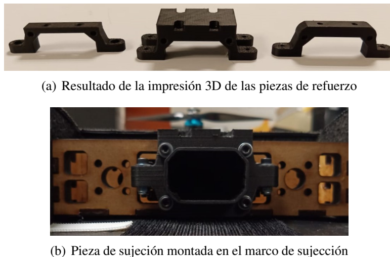
Figura 5.8: Refuerzo fabricado en Onix mediante la técnica de FDM.
