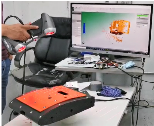
Figura 2.5: Escaneo del fuselaje por medio de escáner láser.
