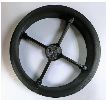
Figura 5.1: Fotografía del Ducted-Fan fabricado mediante FDM utilizando una combinación de materiales. La parte del ducto fue impresa en PLA, mientras que la parte central en Onyx.
