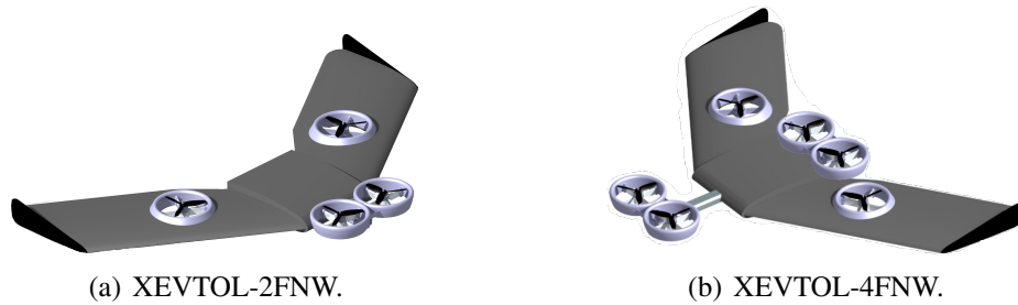
Figura 1.14: Conceptos XEVTOL con dos y cuatro Ducted-Fans integrados en el ala, junto con un sistema basculante Dual Ducted-Fans en la parte delantera para la transición.
