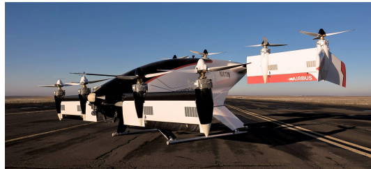
Figura 1.13: Prototipo Vahana desarrollado para la evaluación del concepto de la aeronave. Autor: R. Lyasoff [25].
