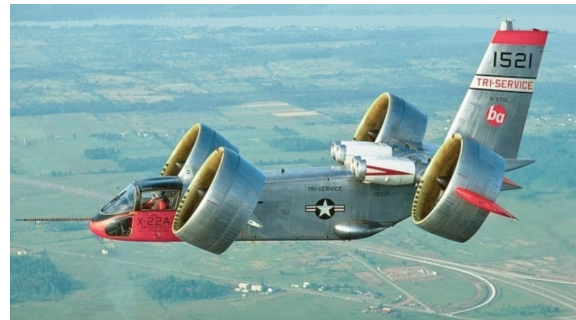
Figura 1.3: Bell X-22A, cuatro Ducted-Fans basculantes. Autor: US Army [12].
