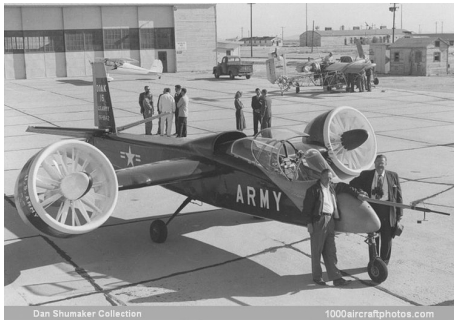
Figura 1.2: Doak VZ-4, dos Ducted-Fans basculantes en las puntas del ala. Autor: D. S. Collection, [11].
