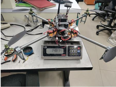
(a) Peso del *Drone* sin batería (1.487 kg).
