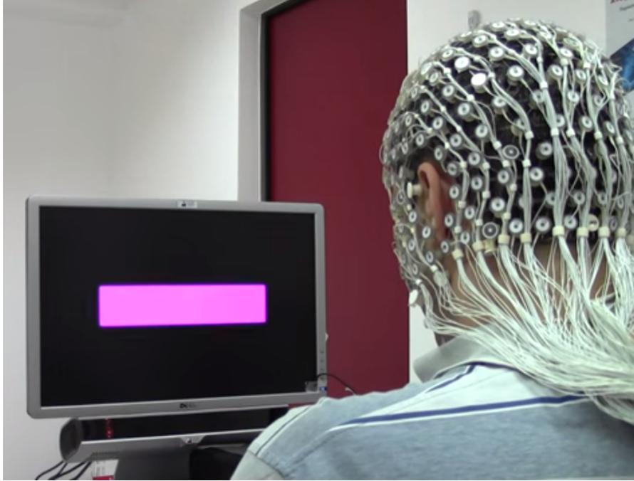
**Figura 8:** Configuración experimental para la adquisición de datos de SSVEP en EEG. Imagen tomada de <https://youtu.be/8lGBVvCX5d8>.
