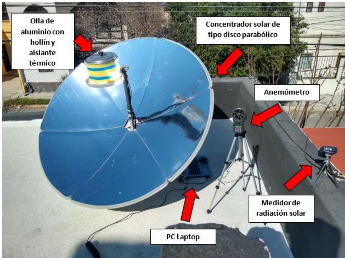
Figura 27. Set de medición de potencia y eficiencia para olla de aluminio con hollín y aislamiento térmico en concentrador solar de disco parabólico.
