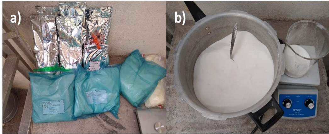
Figura 35. PCM GT. a) Compuestos del PCM GT. b) PCM GT mezclado en polvo y parrilla de calentamiento.
