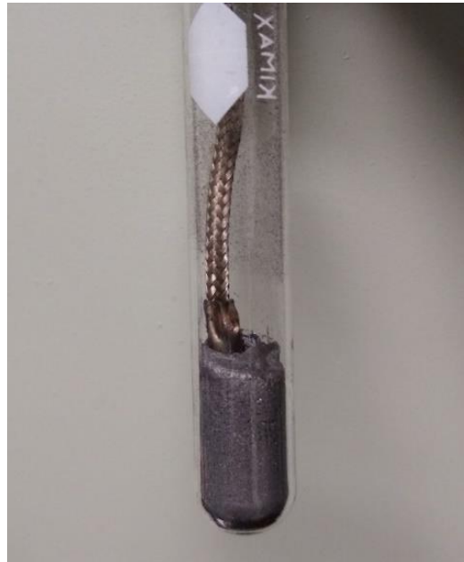
Figura 16. Tubo de ensaye de 10 mm x 10 cm con termopar tipo K en compósito.
