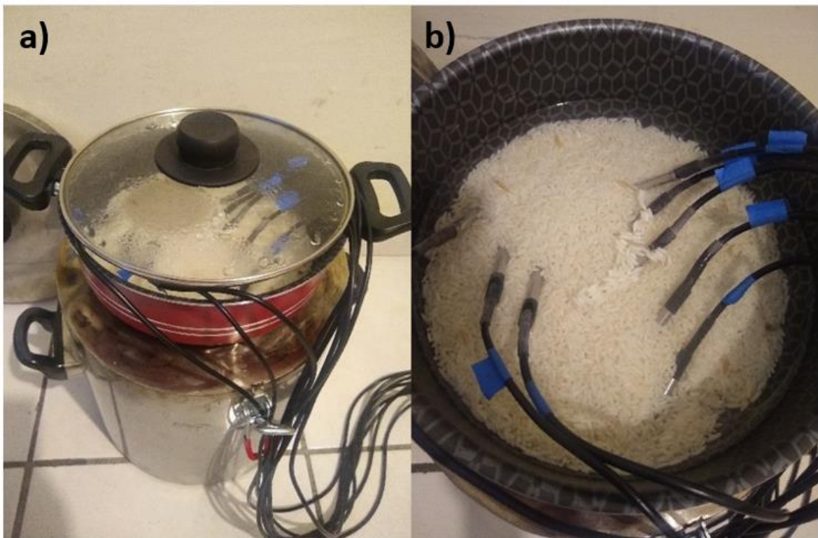
Figura 42. Prueba de cocción de arroz con acumulador térmico. a) Olla con su tapa y arroz en su interior sobre acumulador térmico. b) Olla con arroz y agua destapada y 8 sensores de temperatura DS18B20.
