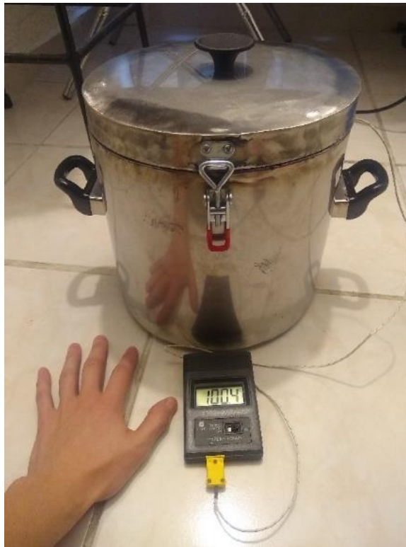
Figura 37. Acumulador térmico terminado a 100.4 °C debajo de su tapa.
