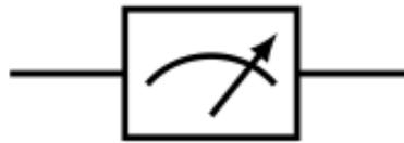
Figura 3.10: Representación de la operación de medición en un circuito cuántico.
