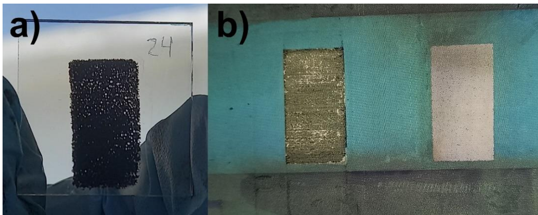
Figura 11. Fotografías de los depósitos de la pasta de carbono obtenidos por serigrafía, donde a) impresión sobre sustrato de vidrio y b) pantalla posterior a la impresión.
