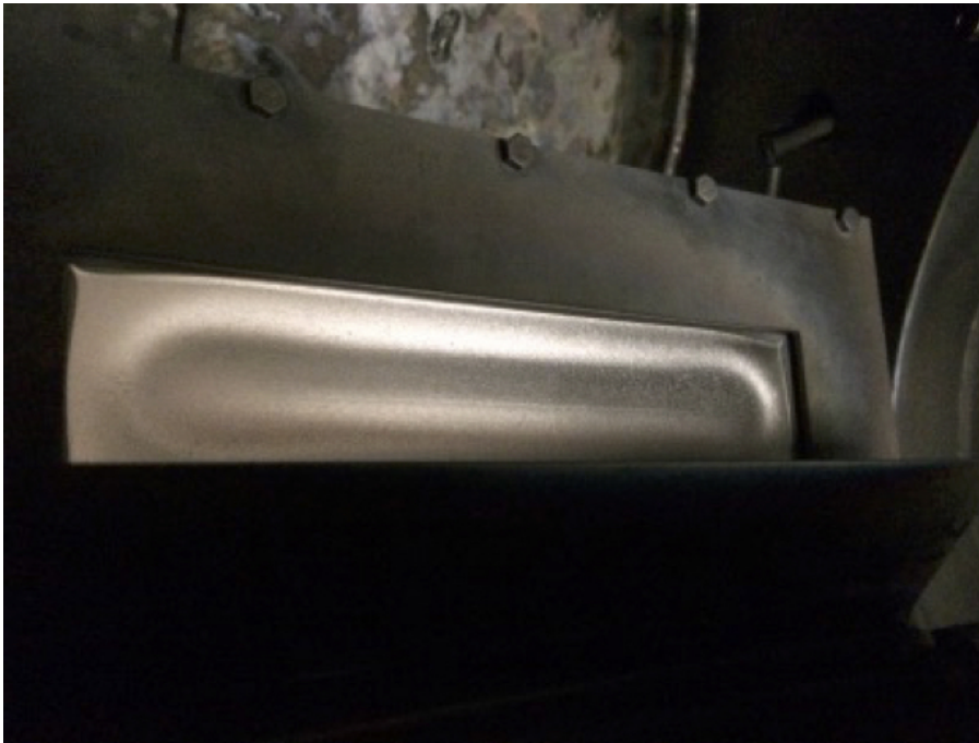
Figura 2.3: Erosión de un blanco metálico utilizado en la técnica de magnetron sputtering.
