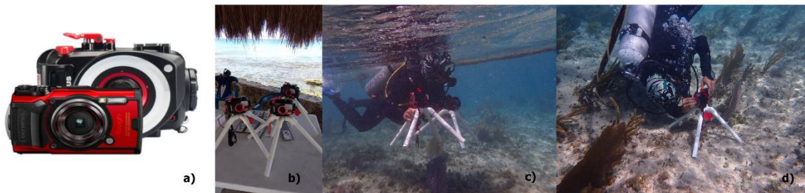
Fig. 3. Equipo fotográfico y posicionamiento en sitios de trasplantes de los programas de restauración de corales. Donde: a) Olympus TG-6's Though con carcasa submarina PT-059. b) Instalación de cuatri-pies a cámaras Olympus TG-6's Though con carcasa submarina PT-059. c) Transporte de cámaras en el sitio de trasplantes La Palmata . d) Posicionamiento de cámaras en sitios de trasplantes de La Palmata .
