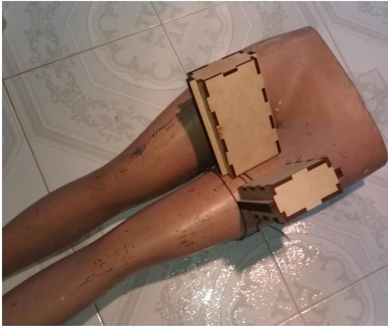
Fig. 52. Aplicadores colocados sobre el maniquí para emular un tratamiento de hipertermia.
