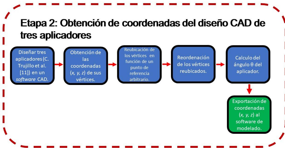
Fig. 7. Flujo de trabajo de la Etapa 2. En esencia esta etapa es una extensión de la Etapa 1, implementando un arreglo de tres aplicadores y un cilindro con medidas antropométricas además de la adición de la exportación de las coordenadas (x, y, z) de los vértices de los aplicadores al software de modelado.
