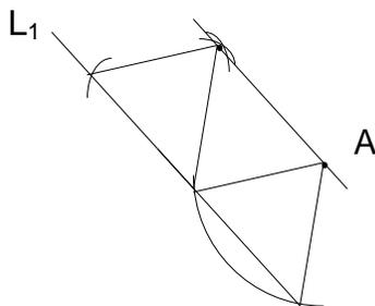
Otra manera de trazar paralelas es utilizando la construcción que acaban de utilizar para la reproducción de dos ángulos:
