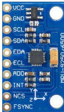
Fig. 29. Módulo acelerómetro con giroscopio MPU9250.
