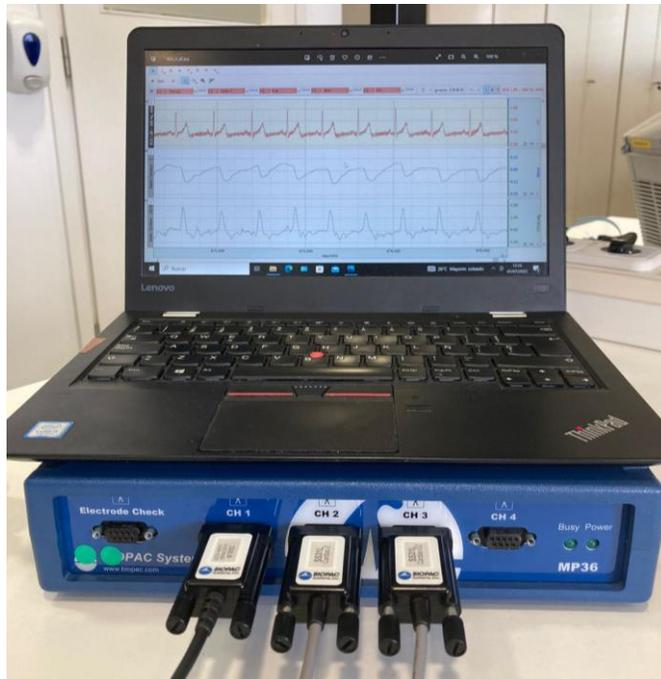
Fig. 47. Señales adquiridas con el sistema BIOPAC MP36 (ECG, ICG(Z),  $ICG(\frac{dZ}{dt})$ ).
