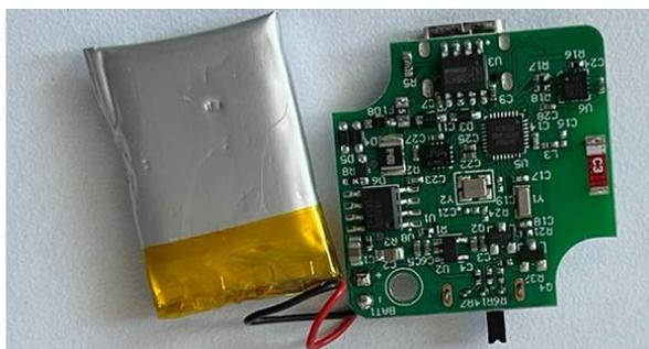
Fig. 11. Tarjeta PCB del sensor, incluye el nRF52832 que es un *System on a Chip* (SoC) integra principalmente el módulo bluetooth y un Cortex-M4 con FPU además del sensor IMU MPU-9250.
