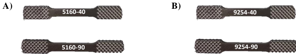
Figura 43. Probetas para pruebas de tensión A) grupo de acero AISI/SAE 5160 B) grupo de acero SAE 9254.
