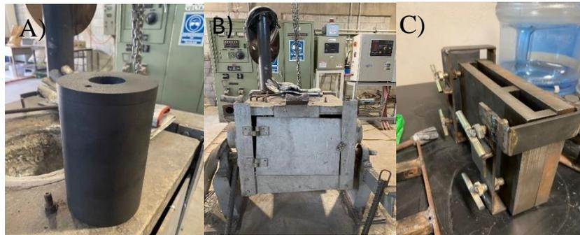
*Figura 6. Crisol, horno y molde utilizados en el proceso de fusión.*
