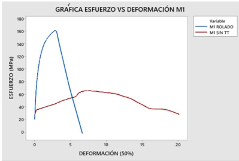
Figura 33. Diagrama esfuerzo-deformación de M1 antes y después del proceso de rolado unidireccional al 50%.
