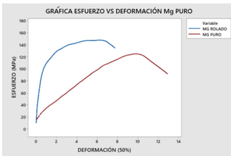
Figura 32. Diagrama esfuerzo-deformación del magnesio puro antes y después del proceso de rolado unidireccional al 50%.
