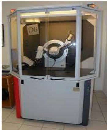
*Figura 15. Difractor de rayos X modelo Bruker D8 Advance*
