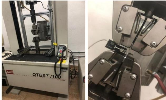
Figura 12. Equipo de ensayos universales QTEST/100 y extensómetro 632.29F-30.
