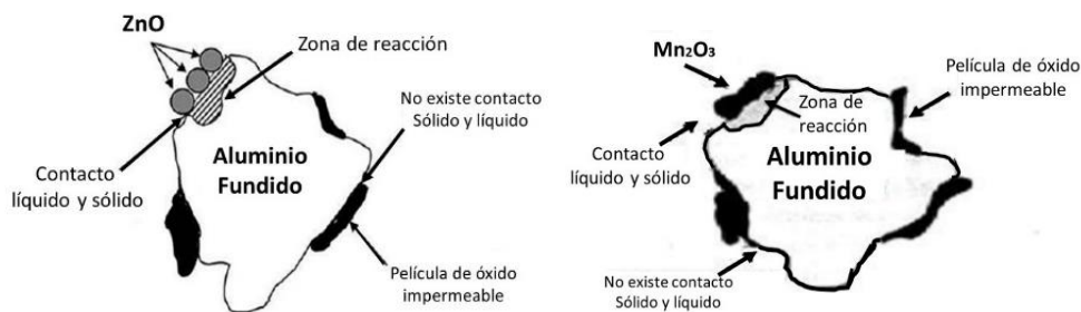
Figura 1. Esquema del posible mecanismo de la reacción aluminotérmica de polvos de masa negra (ZnO - Mn 2 O 3 ) [18].
