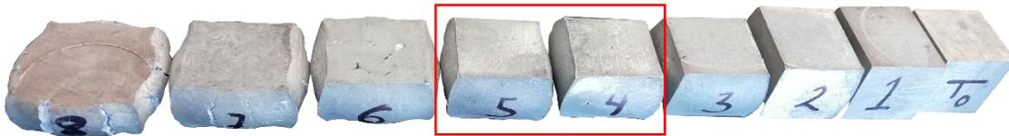
*Figura 21. Prueba previa de deformación con un porcentaje de reducción del espesor original de 0, 5, 10, 15, 20, 25, 30, 40 y 50 por ciento iniciando de derecha a izquierda respectivamente.*
