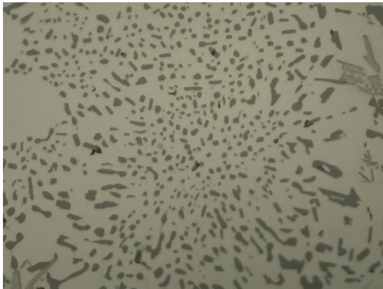
*Figura 25. Imagen original de la aleación de aluminio previo al procesamiento con ImageJ.*
