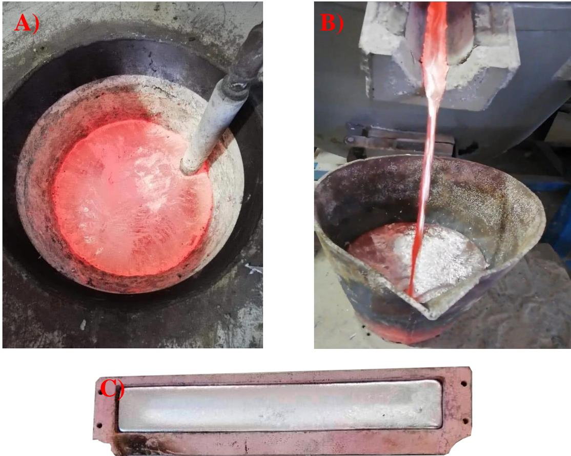
*Figura 18. Proceso de fundición de chatarra. A) Metal líquido libre de escoria. B) Vaciado de aluminio líquido. C) Solidificación de aluminio líquido en lingoteras.*
