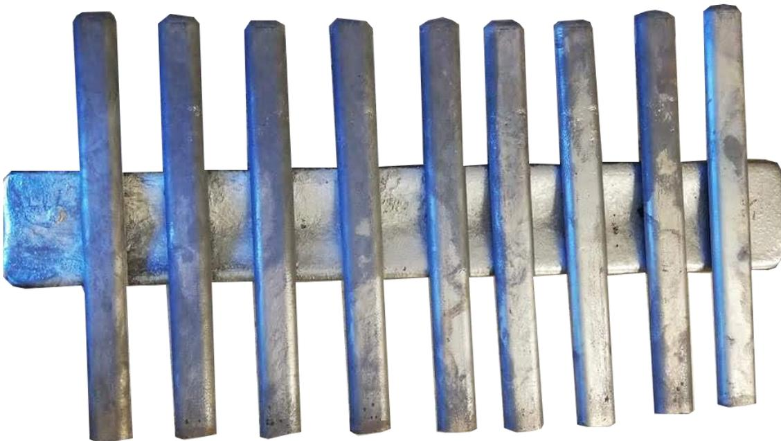
*Figura 20. Piezas posteriores al corte y previo a ser sometidas a tratamiento térmico.*
