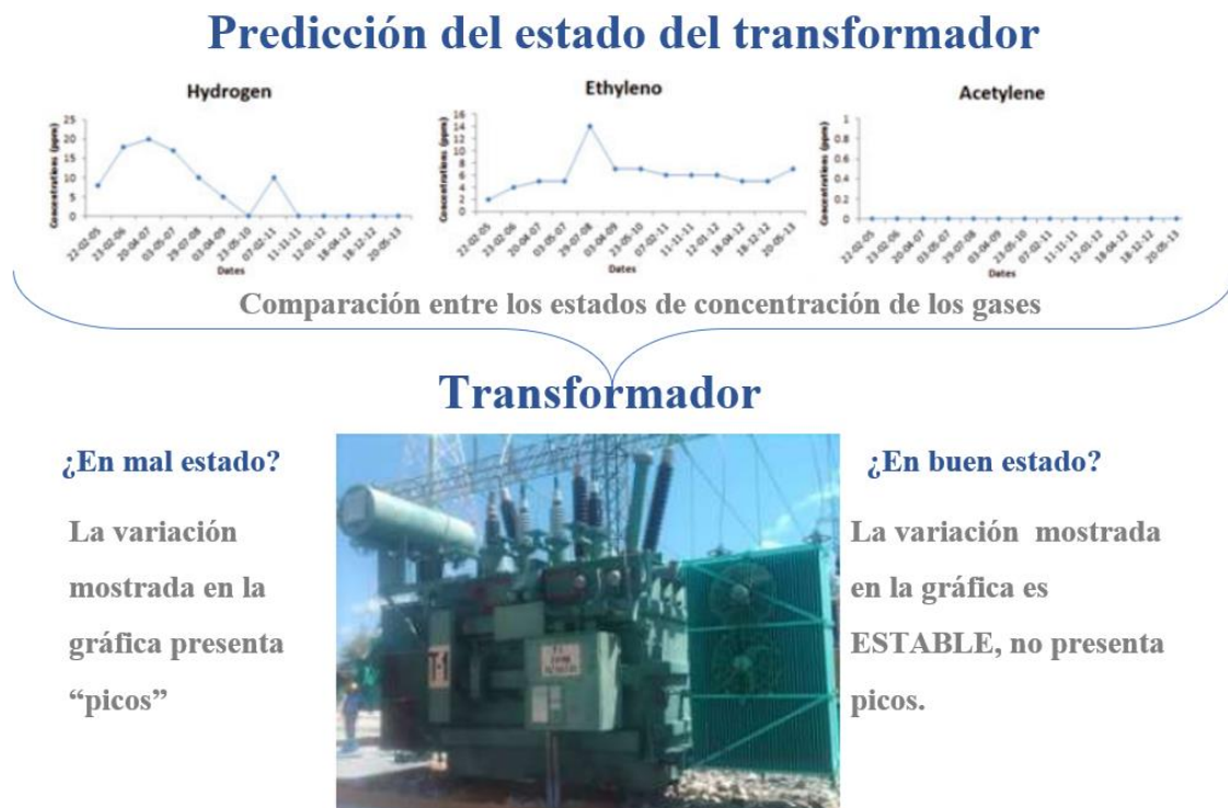
Figura 5. Predecir el estado de un transformador partiendo del comportamiento de gráfico de gases. Adaptado de Torres (2013), Pérez-Oxté (2015), Pérez-Oxté y Cordero (2022).
