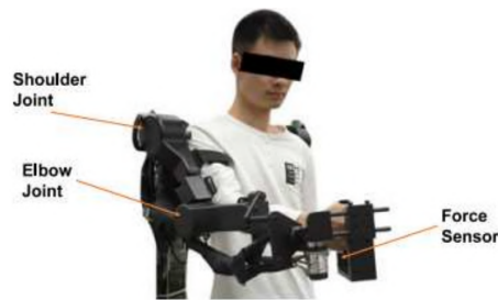
Figura 1.4: Sistema Exoesqueleto desarrollado por Li, Zhijun, t. al. [9], conformado por articulación de hombro y codo.
