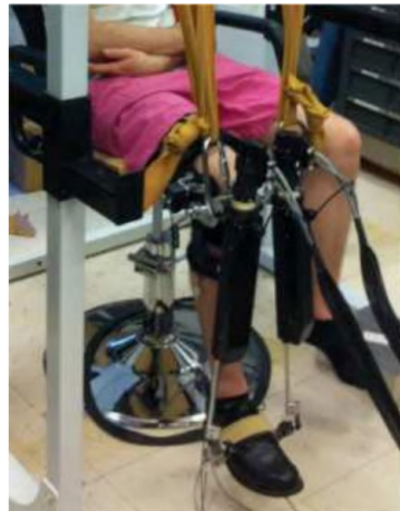
Figura 1.3: Anklebot , Robot de 3 GDL utilizado para la movilidad del tobillo en [8].
