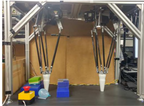
Figura 1.6: Prueba del esquema de teleoperación bilateral con robots delta realizado en [18], basado en el enfoque de funciones de transferencia desarrollado en [17].
