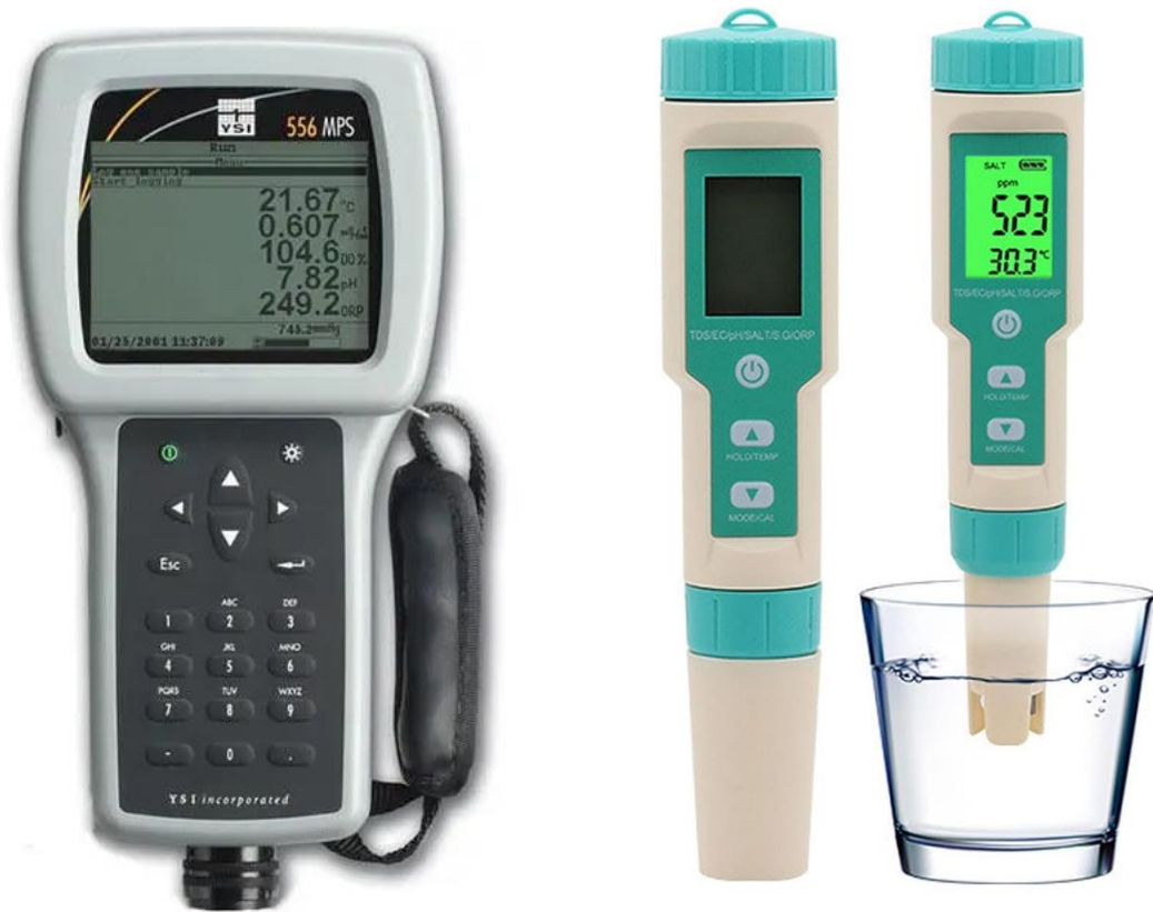
Figura 4. Equipos utilizados para la medición de variables fisicoquímicas en campo: multiparámetro YSI (izquierda) y potenciómetro (derecha).
