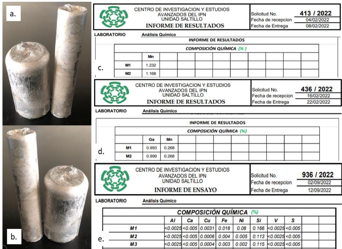
Figura 10. Lingotes obtenidos de las aleaciones a) Mg-1Mn y b) Mg-0.99Ga-0.2Mn; c) resultados del análisis químico mediante ICP de los lingotes de la aleación Mg-1Mn; d) resultados del análisis químico mediante ICP de los lingotes de la aleación Mg-0.99Ga-0.2Mn y, e) composición química de elementos secundarios presentes en M1 lingote de Mg puro, M2 lingotes de la aleación Mg-1Mn y M3 lingotes de la aleación Mg-0.99Ga-0.2Mn.
