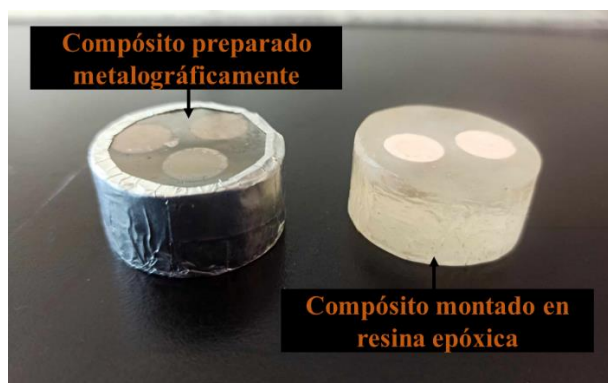
Figura 28. Fotografía de compuesto sinterizado de topacio/corindón montado en resina y preparado mediante desbaste y pulido a espejo.
